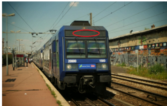
Un exemple d'anomalie identifiable : la girouette (bandeau lumineux indiquant la mission du train) ne fonctionne pas.
